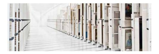
Nur selten ist eine tragfähige Stahlrahmenkonstruktion erforderlich Store Terra-Rahmen bewegen sich ebenfalls nahezu erschütterungsfrei und sind extrem stabil. Da die Rahmen nicht aufgehängt werden, erfordert diese Konstruktion nur selten einen tragfähigen Stahlrahmen. Auch bei diesem System werden die Maße der Rahmen an die Größe der Gemälde und den verfügbaren Platz angepasst. Alternativ können die Schienen auch in einen Betonboden eingelassen werden.
